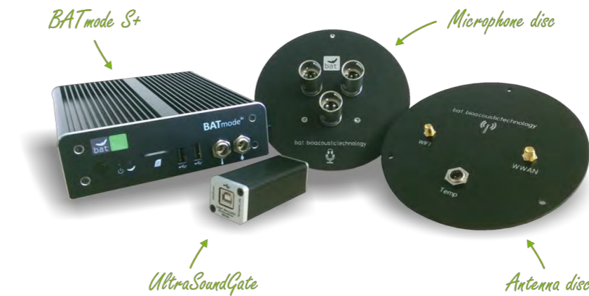
Figure 2 : Dispositif installé dans la nacelle d'éolienne (copyright : B.A.T.)
